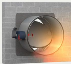
Das Feuer bricht aus, die Temperatur erreicht 72 °C. Durch das geschmolzene Schmelzlot wird die manuelle Brandschutzklappe geschlossen.
